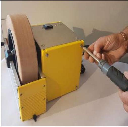
1- Après avoir débranché la machine, retirer le capot plastique opposé à l'interrupteur à l'aide d'un tournevis.
