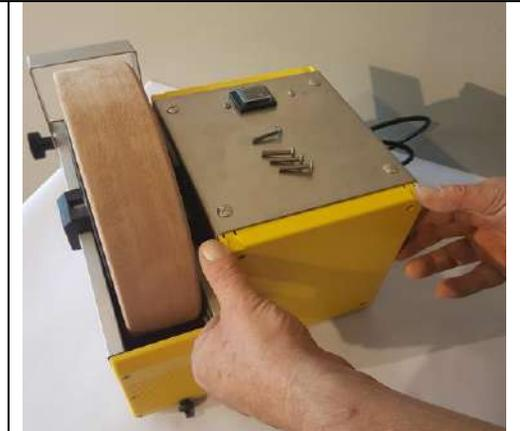
4- Remettre le capot plastique sur le carter en tôle.
